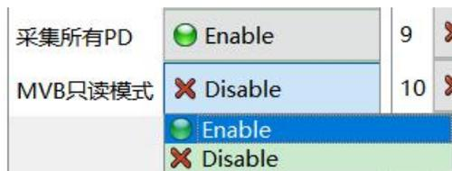
如果 MVB 只读模式 Enable，则 MVB-EMD 工作在纯接收模式，不会向 MVB 总线发送包括设备状态及 PD 在内的任何帧。
