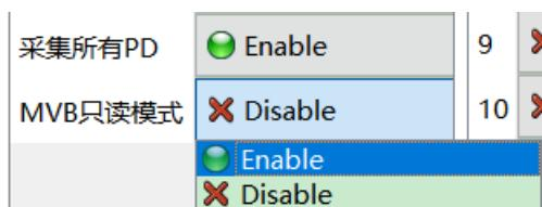
如果 MVB 只读模式 Enable，则 MVB-UART 模块工作在纯接收模式，不会向 MVB 总线输出包括设备状态及 PD 在内的所有帧。
