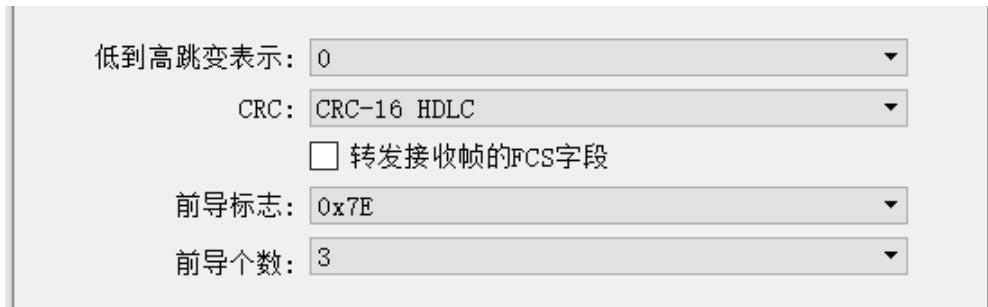
曼彻斯特编码格式除了与 NRZI 相同的配置参数外，还有数据线波形低到高的跳变含义的参数：
