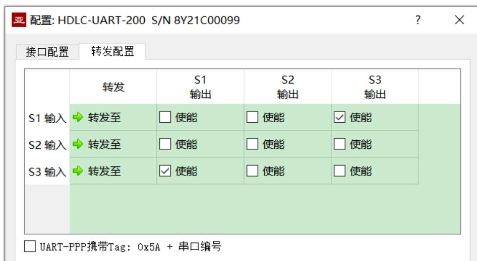
如果勾选“UART-PPP 携带 Tag”，UART-PPP 帧前增加 0x5A 标记及通道编号字段（1 字节）。在串口一对一转发时，不建议勾选。当两个串口输入转发至一个串口时，可以勾选该选项，使得上位机能够获得源串口信息。
