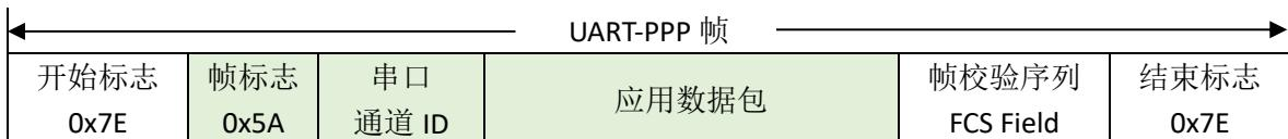
由于应用数据包和帧校验字段有可能出现 0x7E，因此收发双方需要对应用数据包和帧校验字段进行字符转义，转义规则如下：
