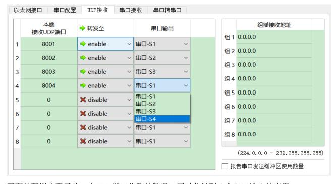
下面的配置实现了从一个 UDP 端口收到的数据,同时分发到 4 个串口输出的应用:
