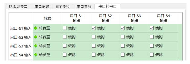
如上图所示的配置,实现了串口 S1 的输入分路至 S2、S3、S4 输出的应用。HDLC-ETH 对接收进行存储转发,就算是 S1、S2、S3、S4 的波特率、时钟模式不同,也不会丢包。
